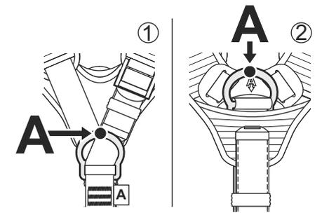
**ATTACHING WORK POSITIONING / RESTRAINT SYSTEM (EN358)**
